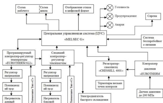
Рис.59. Блок-схема системы управления установкой горячего изостатического прессования.
