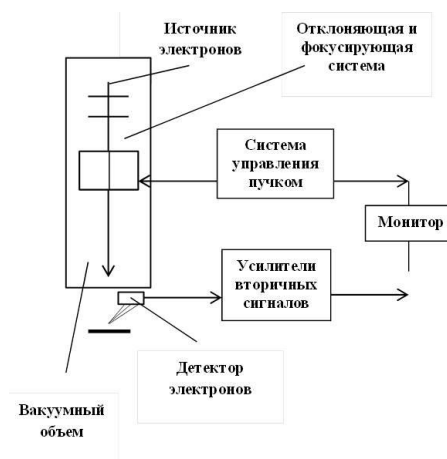
Рис. 65. Упрощенная блок-схема растрового электронного микроскопа.
