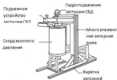
Рис.56. Общий вид модуля СВД в положении загрузки (СВД открыт).
